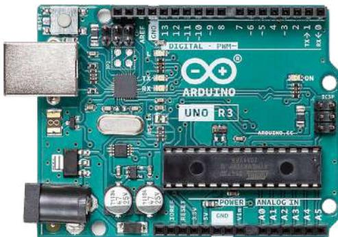
Una placa clásica muy utilizada en educación, ideal para introducir a los estudiantes en la programación, la electrónica y la creación de prototipos. El diseño sencillo y el sólido ecosistema de soporte de la placa UNO R3 la hacen perfecta para principiantes. Con amplios recursos en línea, una configuración sencilla y compatibilidad con numerosos sensores y módulos, UNO R3 sigue siendo una piedra angular para el aprendizaje práctico de la educación STEM.
